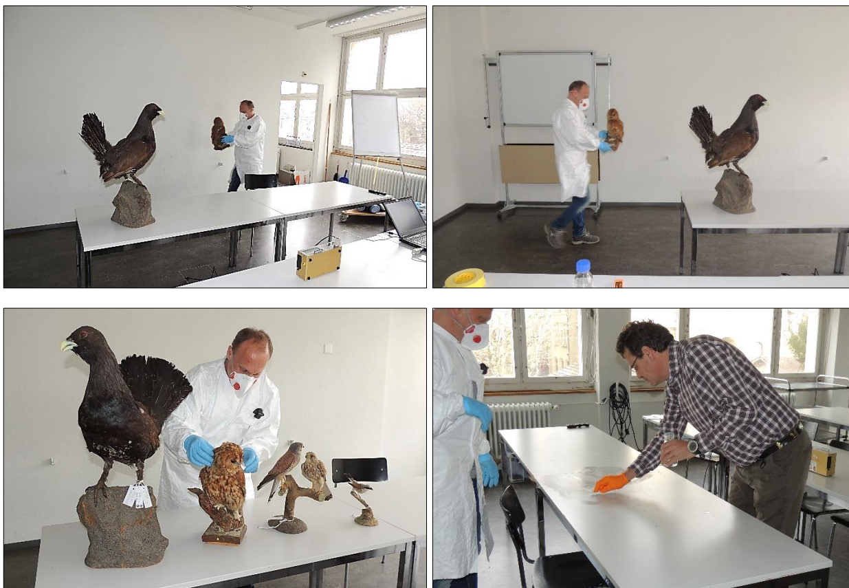
Abb. 7: Simulationsversuch im Schulunterricht mit Vogelpräparaten. Am Ende der Schulstunde wurde der Staub auf dem Manipulationstisch beprobt (rechts unten)
