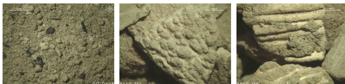
Kesselasche/E-Filterstaub Probe G17: Übersicht und grössere Mörtel-Partikel (Rohrleitungsisolationen)
