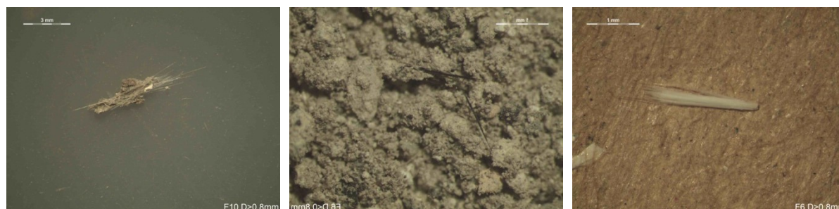
Künstliche Mineralfasern (KMF) in der Schlacke (Proben F6 und F10)
