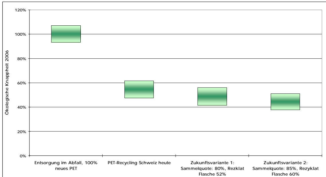
Abbildung 14 Vergleich der Gesamtumweltauswirkung Ökologische Knappheit '06 (UBP) zwischen dem Basisszenario, dem IST-Zustand des PET-Recyclings in der Schweiz und zwei Zukunftsszenarien. Die Ausdehnung der Balken zeigt die Unsicherheit der Ergebnisse.
