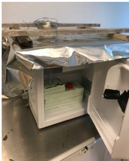
Abbildung 3: gekühlter Regenwassersammler nach Mazacek
