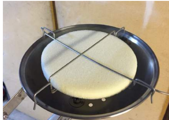
Abbildung 7: Offener Sammler mit PU-Schaum Halterung
