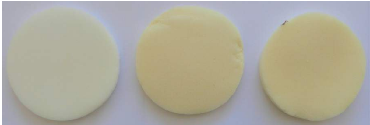
Abbildung 10: Polyurethan-Schäume (PU), links: frischer PU, Mitte: PU nach zweiwöchiger Exposition, rechts: PU nach vierwöchiger Exposition.
